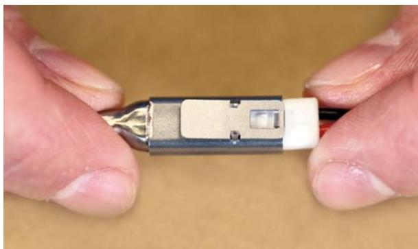
Steckerkomponente bis zur Verriegelung zusammenfügen
