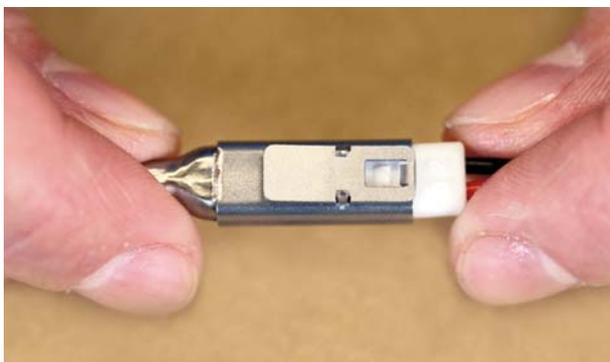
Steckerkomponente bis zur Verriegelung zusammenfügen
