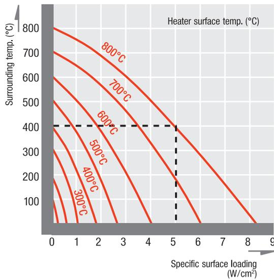
在空气中工作的加热器护套上的温度也取决于环境温度
