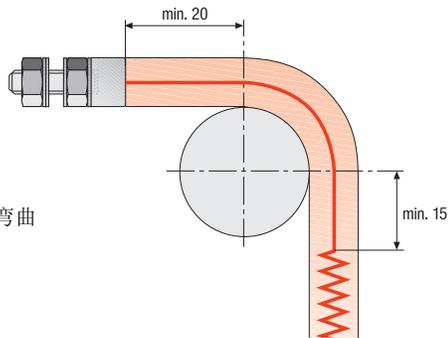
在订货时需要说明管状加热器是否由客户自己弯曲成型。加热器的表面不能被榔头冲击或产生疤痕损坏。一旦管状加热管被弯曲，不能在相同的折弯点反向弯曲。
