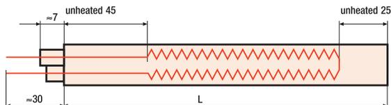
由于生产原因，所有扁平管式加热器的远端都有一个非加热的区域，其最小长度25毫米，连接端的非加热区最小长度45毫米。如果需要较长的非加热区，请在订货时说明。如需要的话，也可以在一或两个端上加强功率分布。
